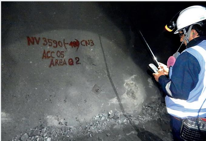
*Se verificó que la velocidad de aire no sea menor de 20 m/min y cuando se emplea ANFO u otros agentes de voladura, la velocidad de aire no sea menor de 25 m/min. Asimismo, se verificó la cobertura del requerimiento de aire en las labores mineras.*
