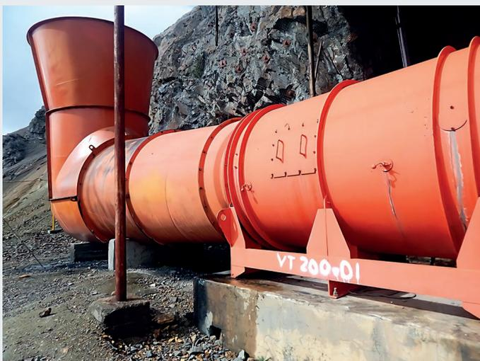
*Se verificó que los ventiladores principales cuenten con protección para evitar su destrucción, así como con silenciadores, dispositivos automáticos de alarma para casos de paradas y, por lo menos, dos fuentes de energía independientes.*
