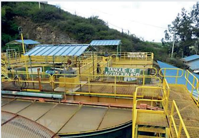
Tanques de agitación (lixiviación) provistos con barandas y mallas metálicas de resguardo en la parte superior.
