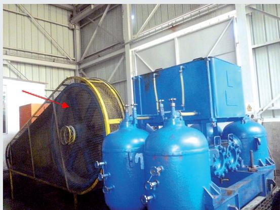
Sistema de transmisión de bomba Wars con guarda de protección para evitar contacto del trabajador con los elementos móviles.
