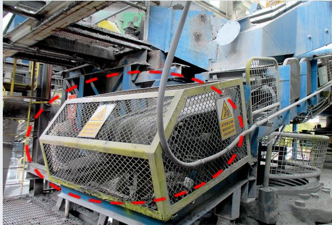
Polea de cola de faja transportadora implementada con guarda de protección para evitar el contacto de los trabajadores.
